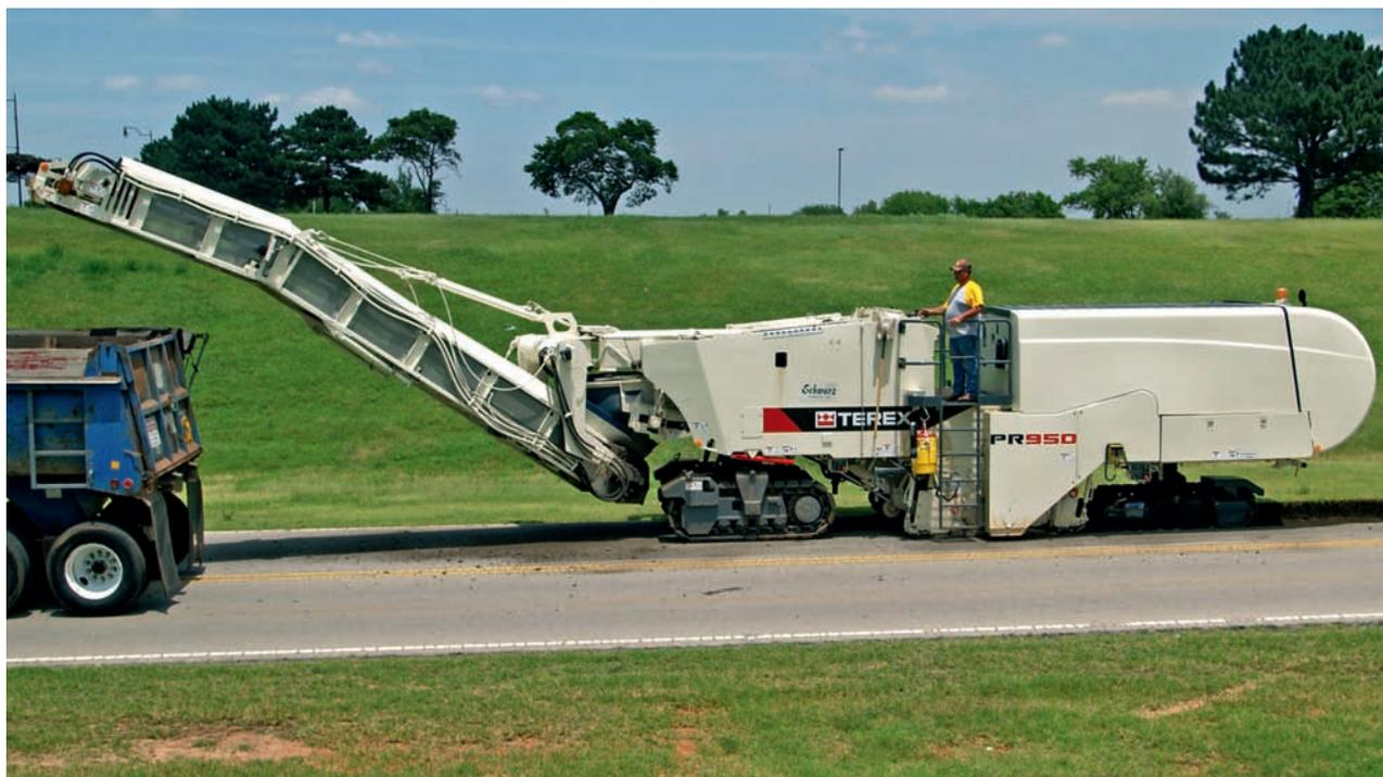
Дорожные фрезы для холодной планировки TEREX, также называемые фрезерными машинами, а иногда и профилировщиками дорожных покрытий, позволяют осуществлять управляемое (частичное или полное) удаление уложенных дорожных покрытий. Эти машины используются в основном для подготовки профиля к укладке горячей асфальтобетонной смеси другими машинами при нанесении слоя износа, асфальто-щебневого покрытия, эмульгированной гидроизоляционной битумной мастики или поверхностного микрослоя.
